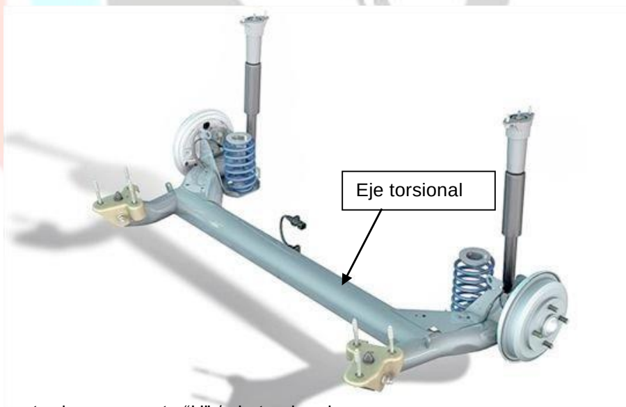
Brazo arrastrado con puente "H" / eje torsional.
